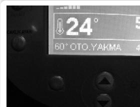
**5.** Второй счетчик времени начнет отчет времени до заданного ранее значения. Панель управления начнет выполнять операцию автоматического розжига. После завершения автоматического розжига панель управления перейдет в стандартный режим работы.
